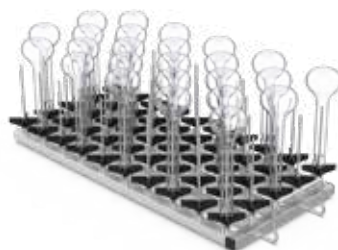
PLWT-50 Модуль инжекторный 1/2 для колб для 50 колб объемом 10-100 мл
